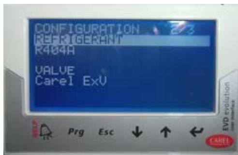
4. Sélectionner **REFRIGERANT** et appuyer sur le bouton Entrée puis sur les « Flèches haut/bas » jusqu'à atteindre **Refrigerant R744**.
