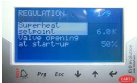
19. Sélectionner **Valve opening at start-up** et appuyer sur ↵
