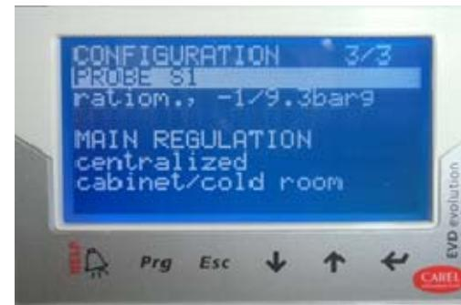
8. Appuyer sur les « Flèches haut/bas » jusqu'à sélectionner « **ratiohm. 0/45 barg** » puis appuyer à nouveau sur
