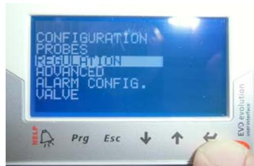
17. Sélectionner **Superheat setpoint** et appuyer sur **←**
